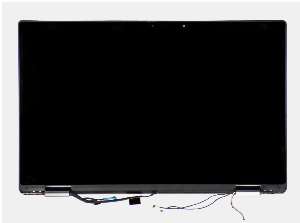
Figure 1. Assemblage d'écran avec câbles d'antenne
